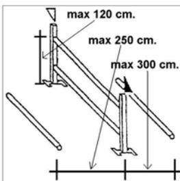
Barriere di invito possono essere collocate a terra davanti ad ostacoli verticali ad una distanza non superiore a m. 1,00 dagli ostacoli stessi. In questo caso possono essere collocate barriere anche al di là degli ostacoli verticali, cioè dalla parte dove il cavallo si riceve, sempre ad una distanza uguale e massima di un metro.
